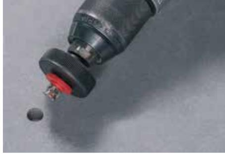
Zur einfachen und sicheren Montage werden Systemaufsätze der Firma fischer Deutschland GmbH empfohlen. Der Fischer | FZP-K (Tergo+) Anker wird mit dem Gewinde in das Setzwerkzeug bis zum Anschlag eingedreht.
