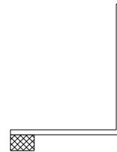
Positionierung des Schaumstoffstreifens 6 x 9 auf Metall-Uk L-Profil
