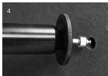
Fassadentafel liegend vorbohren, ggf. Bohrshablone verwenden. Empfohlener Bohrer: Spezialbohrer für Faserzement  $\varnothing = 9,5$  mm.
