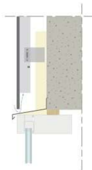
Рисунок 26: EQUITONE и основание светопрозрачного фасада
