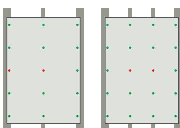
Если при расчетах шаг подсистемы был уменьшен и нет центральной направляющей за панелью, то возможен монтаж фиксированных точек крепления панелей на средних профилях, или фиксированные точки крепления могут располагаться как можно ближе к центру панели.
