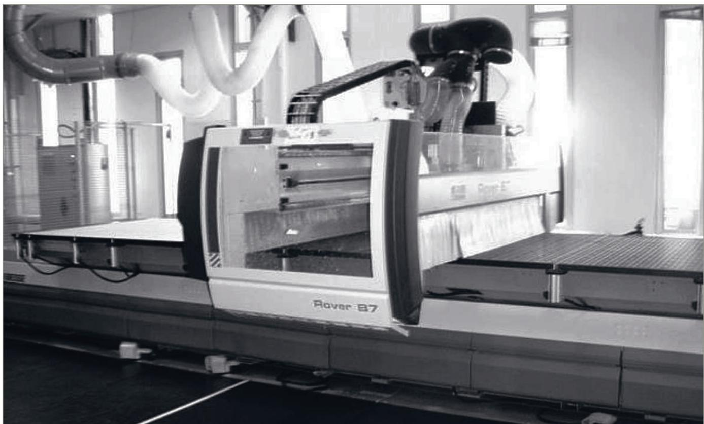
CNC-станок Bohr- und Fräsammat Biesse Rover B-7
