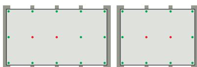
Если на объекте применяются узкие панели EQUITONE, крепление которых будет осуществляться только на двух параллельных направляющих, важно учесть вертикальный разрыв в подсистеме.
