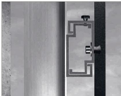
Для скрытой системы монтажа плит EQUITONE существуют три типа крепления, одобренные производителем панелей EQUITONE: Keil, Fischer, SFS (для немецких и бельгийских панелей толщиной 8 мм, 10 мм и 12 мм.)
