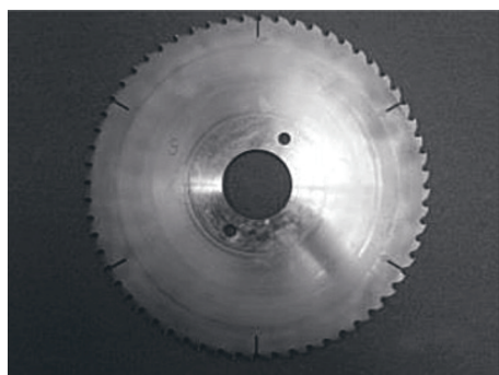
Диск LEUCODIA-Plattenaufteil-Kreissäge 380x4,8/3,5x75 Z60
