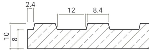
Указанные размеры пазов носят исключительно описательный характер. Это номинальные размеры, к которым применимы допуски. Пазы проходят по листу в продольном направлении. Для получения дополнительной информации свяжитесь, пожалуйста, с представителем компании Etex.
