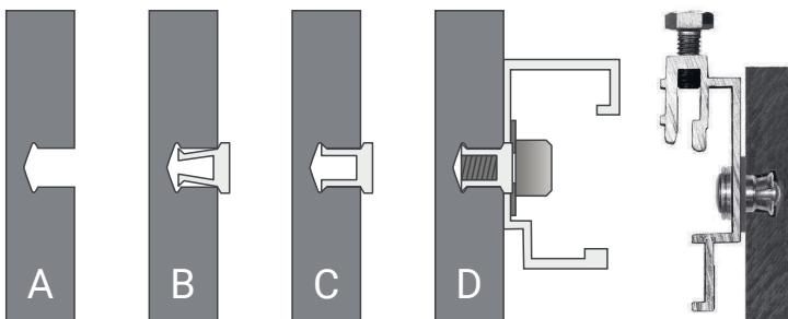
Убедитесь, что отверстия под анкер чистые, без фибронементной пыли (A), установите анкер в монтажное отверстие (B). Через шайбу прислоните подвесные крюки (аграфы) к задней стороне панели и зафиксируйте их на панели при помощи болта. По мере закручивания болта анкер будет раскрываться внутри крепежного отверстия (C). Будьте аккуратны в момент фиксации анкера в панели. Не повредите анкер и фибронементную панель.
