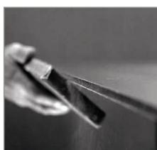
Рекомендуется обработать кромки панелей бруском с закрепленной наждачной бумагой зернистостью 80.
