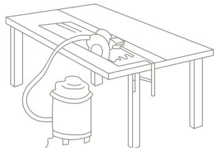
Процесс резки и сверления необходимо производить в сухом и проветриваемом помещении. Опилки и металлическую стружку после сверления подсистемы необходимо незамедлительно удалить с лицевой поверхности фиброцементной панели сухой салфеткой из микрофибры. Опилки и металлическая стружка могут послужить причиной загрязнения продукта.
