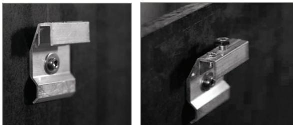
Аграфы располагаются в верхней части панели, имеют регулировочные болты, которые позволяют регулировать панели (вверх и вниз) для обеспечения правильного положения. Для предотвращения сдвигов панели верхние аграфы могут иметь дополнительное отверстие, в которое можно вставить винт или заклепку. Некоторые поставщики подсистем могут поставлять специальные зажимы для предотвращения смещений панели на подсистеме.
