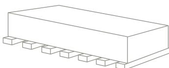
Хранение фиброкерамических панелей EQUITONE осуществляется на палетах, на которых они поставляются (в случае если разгрузка осуществляется механизированным способом), или на поддерживающих брусках (если разгрузка производится вручную).
