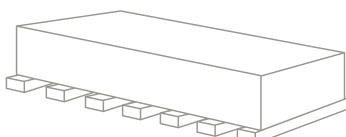
Хранение фиброкерамических панелей EQUITONE осуществляется на палетах, на которых они поставляются (в случае если разгрузка осуществляется механизированным способом), или на поддерживающих брусках (если разгрузка производится вручную).
